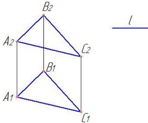
31. Определить величину угла наклона плоскости  $\alpha$  к плоскости  $\Pi_1$ , если  $\alpha$  задана: а) линией ската плоскости  $m(m_1, m_2)$ ; б)  $\triangle ABC$
