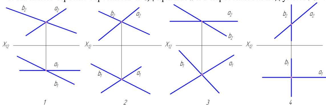
2. На каком чертеже угол  $A$  в  $\triangle ABC$  проецируется в виде прямого?
