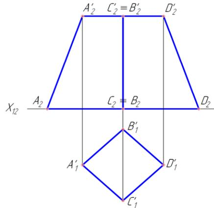
Построить проекции четырехугольной правильной усеченной пирамиды по заданной фронтальной проекции и верхнему основанию  $A'B'C'D'$ . Построить точку  $K$  на высоте 15 мм на правой передней боковой грани. В плоскости грани  $ACA'C'$  построить фронталь  $MN$ .
