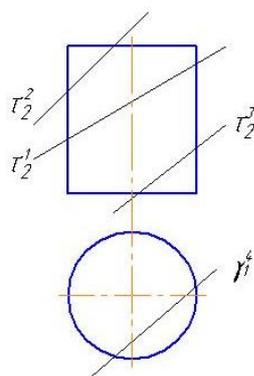
2. Какая форма сечения получится в том случае, если цилиндр вращения будет пересечен наклонной к его оси плоскостью и все образующие цилиндра будут участвовать в пересечении?
