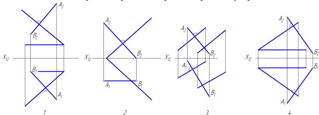
7. На каком чертеже достаточно данных, чтобы начертить проекции перпендикуляра к заданной плоскости, с основанием в т.  $A$ ?
