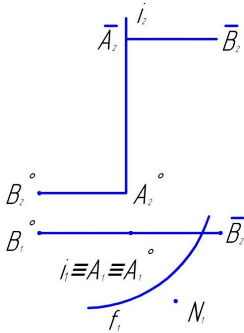
64. Чертеж поверхности наклонного геликоида  $\Phi$  задан проекциями  $i_1, i_2$  его оси  $i$  и проекциями  $A_1^\circ B_1^\circ, A_2^\circ B_2^\circ$  начального положения отрезка  $A^\circ B^\circ$  образующей  $l$  и проекциями  $A_1^* B_1^*, A_2^* B_2^*$  второго положения отрезка  $A^* B^*$  образующей  $l^*$ .
