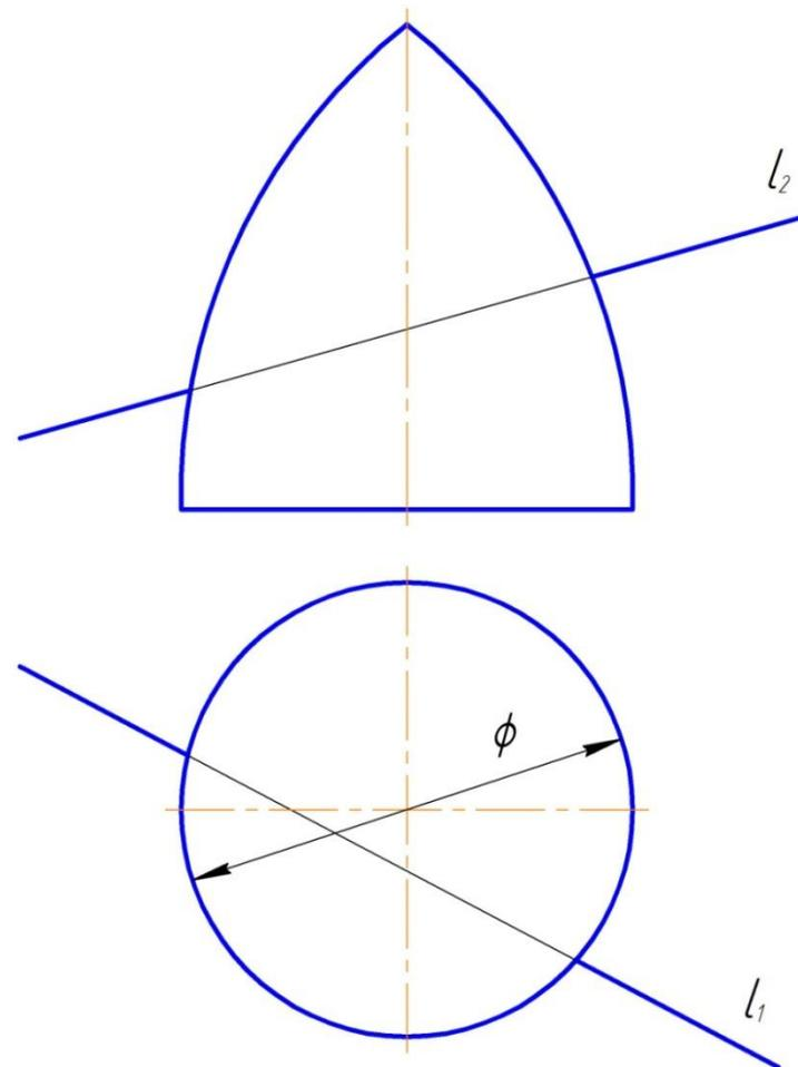
**ПОСТРОИТЬ ПРОЕКЦИИ ЛИНИИ ПЕРЕСЕЧЕНИЯ ДАННЫХ ПОВЕРХНОСТЕЙ.
