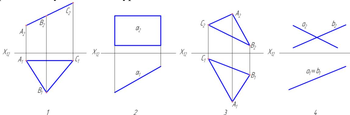
7. На каком чертеже после преобразования угол наклона прямой к плоскости проекций  $\Pi_1 (\perp \alpha)$  проецируется в натуральную величину?
