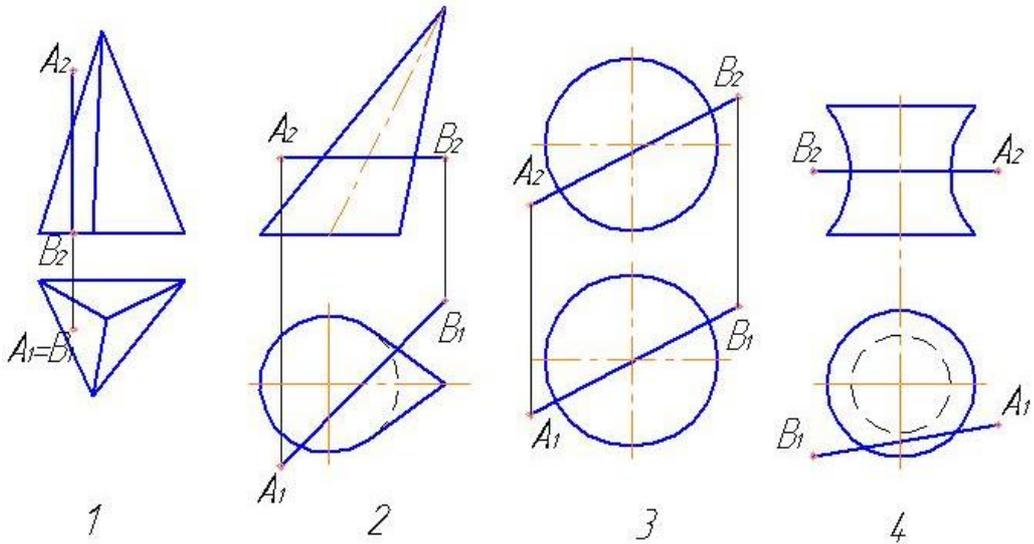
7. На каком чертеже точки пересечения отрезка  $AB$  с поверхностью определены с помощью вспомогательной фронтальной плоскости?
