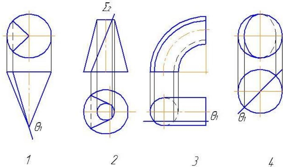
14. На каком чертеже неправильно показана видимость линии пересечения поверхности плоскостью?
