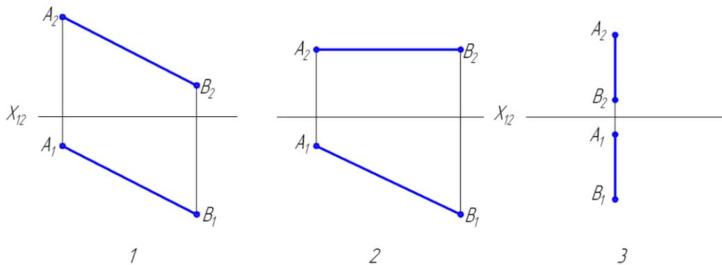
5. На каком чертеже угол  $\beta$  является углом наклона прямой  $AB$  к плоскости  $\Pi_2$ ?
