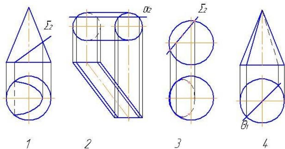
13. На каком чертеже неправильно показана видимость линии пересечения поверхности плоскостью?
