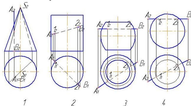
2. С помощью какой секущей плоскости следует решать задачу на пересечение фронтальной прямой с поверхностью шара?
