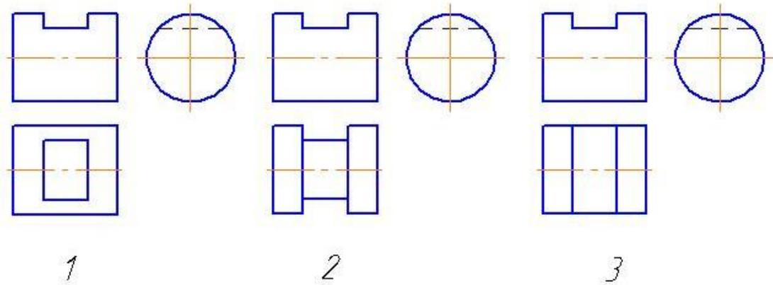
11. На каком чертеже неправильно показана видимость линии пересечения поверхности плоскостью?
