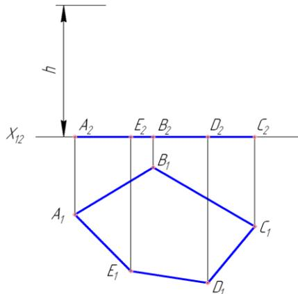
Построить проекции прямой призмы по данному основанию  $ABCDE$  и высоте  $h$ . На боковой поверхности достроить проекции точек:
