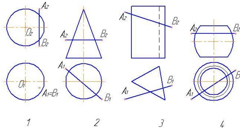
4. На каком чертеже отрезок  $AB$  не пересекает заданную поверхность?
