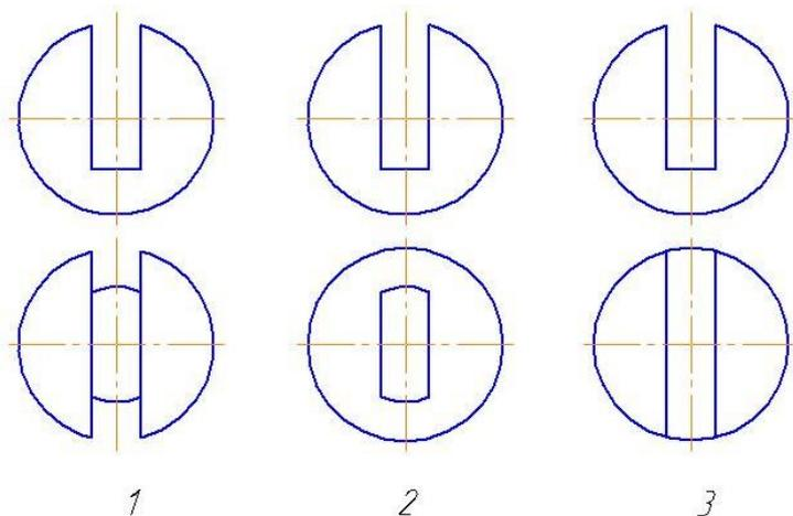
10. На каком чертеже правильно изображена горизонтальная проекция цилиндра с вырезом?
