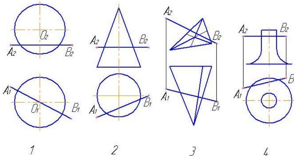
5. На каком чертеже точки пересечения отрезка  $AB$  с поверхностью определены с помощью вспомогательной фронтально-проецирующей плоскости? След плоскости не обозначен.
