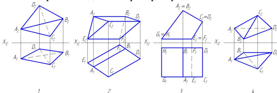
5. На каком чертеже вершина  $B$  многогранника невидима при проецировании на фронтальную плоскость проекций  $\Pi_2$ ? Видимость ребер на чертеже не показана.
