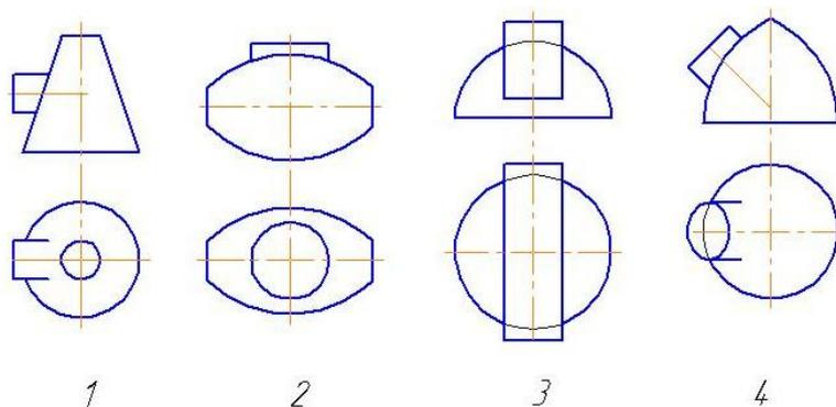
8. При пересечении данных тел получится ... плоских кривых линий.
