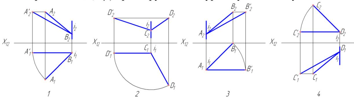
9. На каком чертеже натуральная величина плоской фигуры определена способом вращения вокруг оси, перпендикулярной плоскости проекций  $\Pi_2$ ?
