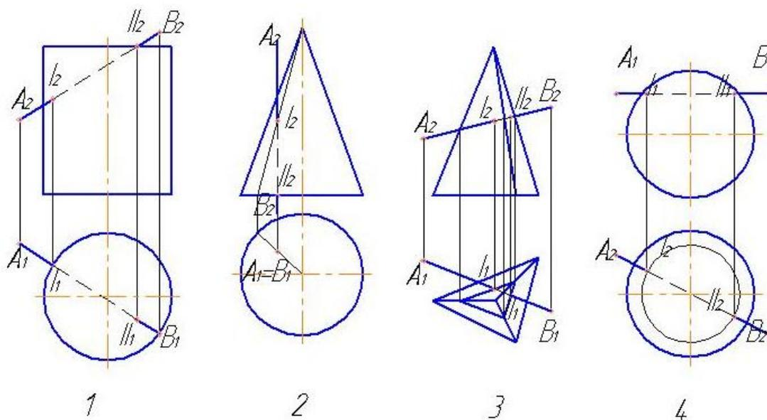
9. Какая фигура получается в сечении конуса плоскостью, проходящей через отрезок  $AB$  и перпендикулярной плоскости проекций  $\Pi_2$ ?
