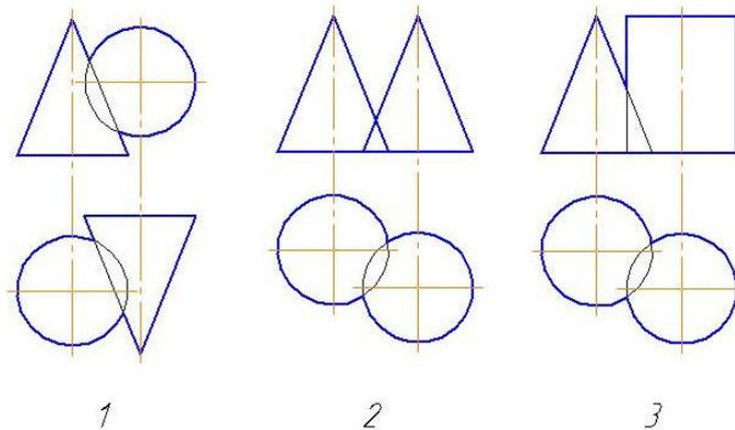
7. На каком чертеже линию пересечения заданных поверхностей можно построить только с помощью вспомогательных секущих плоскостей?
