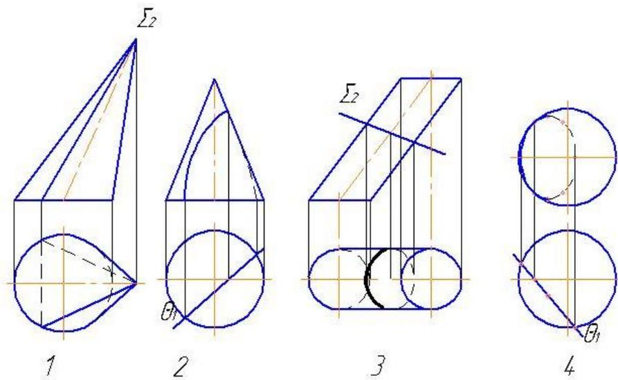
12. На каком чертеже неправильно показана видимость линии пересечения поверхности плоскостью?
