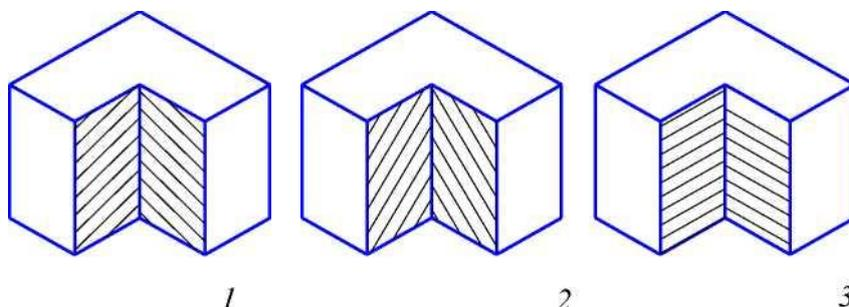
92. Под каким углом наносится штриховка на разрезах и сечениях?
