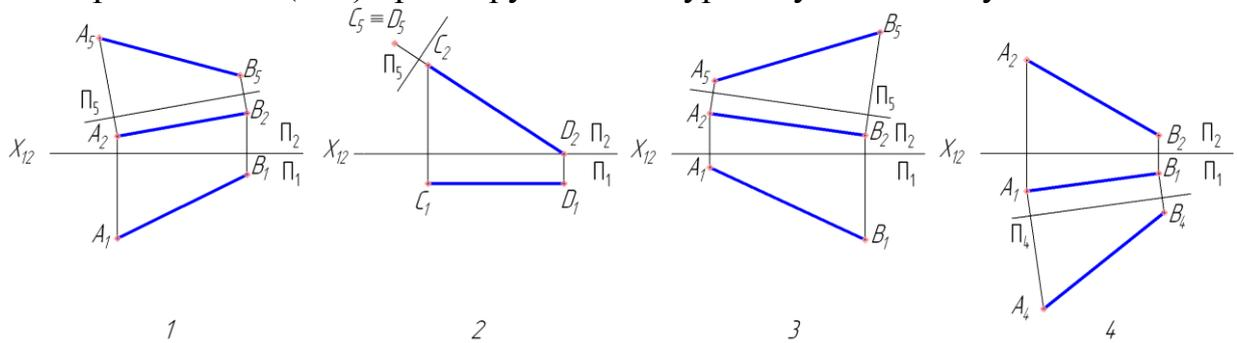
3. На каком чертеже после преобразования угол наклона прямой к плоскости проекций  $\Pi_2$  ( $\angle \beta$ ) проецируется в натуральную величину?
