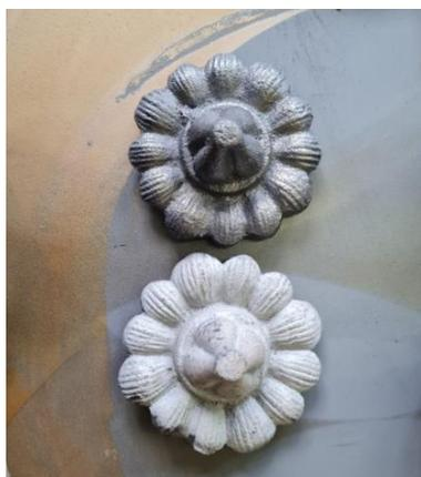
*Рис. 11. Розетка в форме цветка для каркаса покрытия в мастерской.
