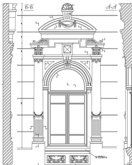
*Рис. 3. Окно второго этажа. Рабочий проект деталей фасадов памятника архитектуры «Б. дом Агамжановых, 1909 г.» (НИПФ «Ярканон», 1998 г.)*
