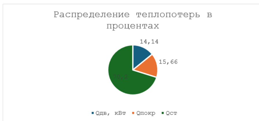
Рис. Распределение теплопотерь через ограждающие конструкции
