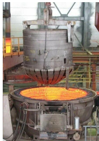
Рис. 2. Установка прямого восстановления
