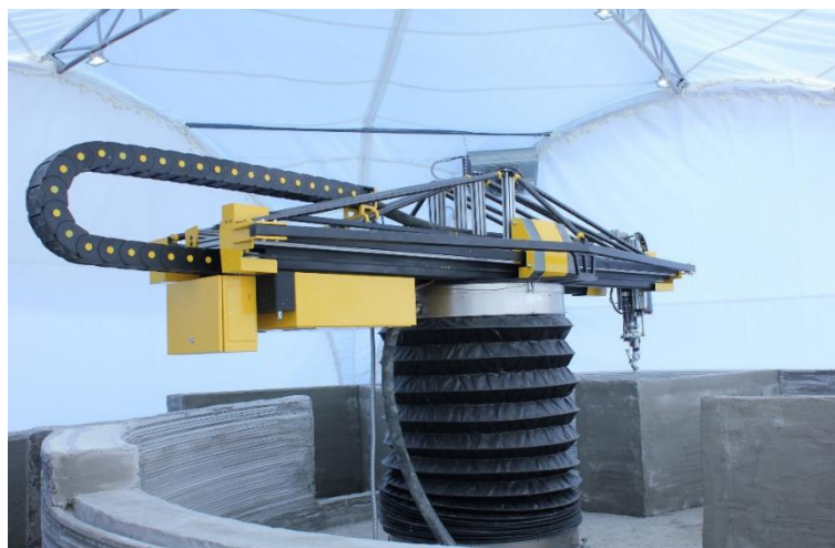
Рис. 2. Роботизированный манипулятор 3D-принтера
