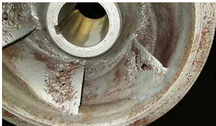
Рис. Повреждения, наносимые эффектом кавитации (часть насоса) [3]
