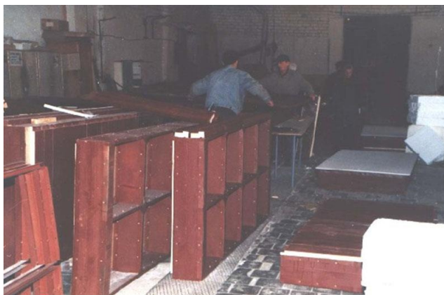
Рис. 4. Сборка сотовых конструкций из элевита
